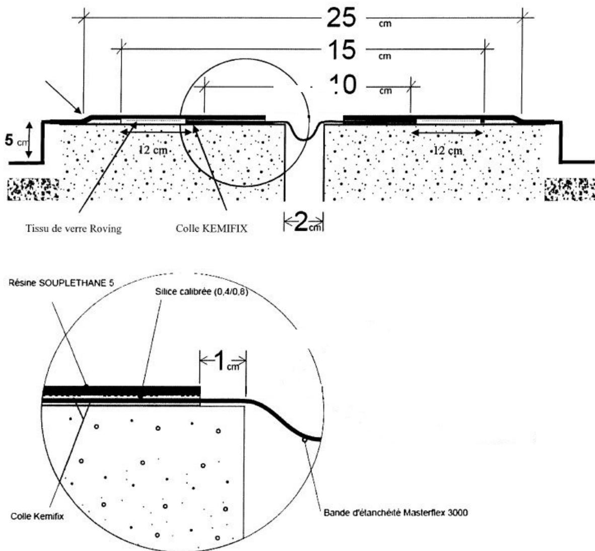
**Figure 6 – Traitement des joints de dilatations des terrasses accessibles**
