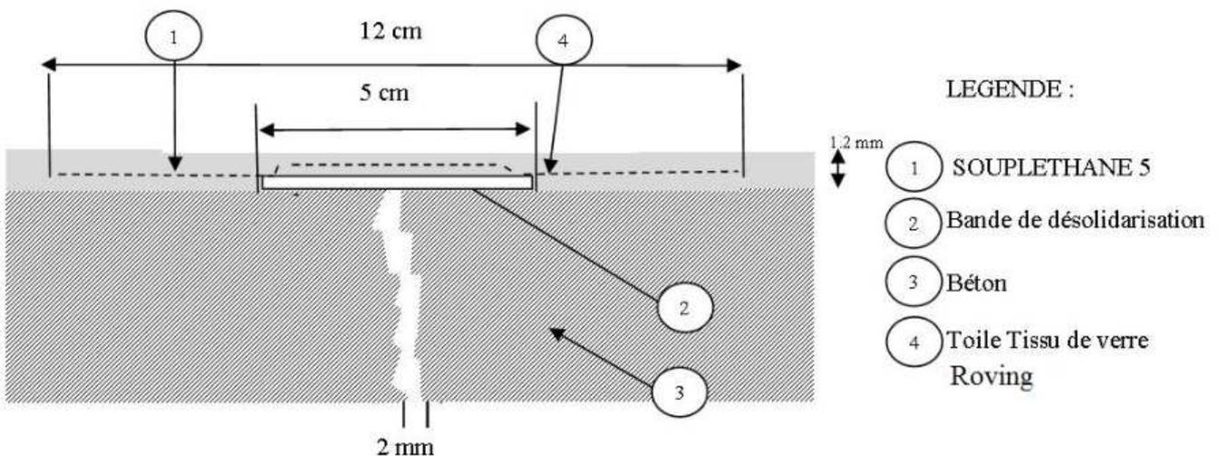
Figure 2 – Traitement des fissures d'ouverture supérieure à 2 mm et < 10 mm
