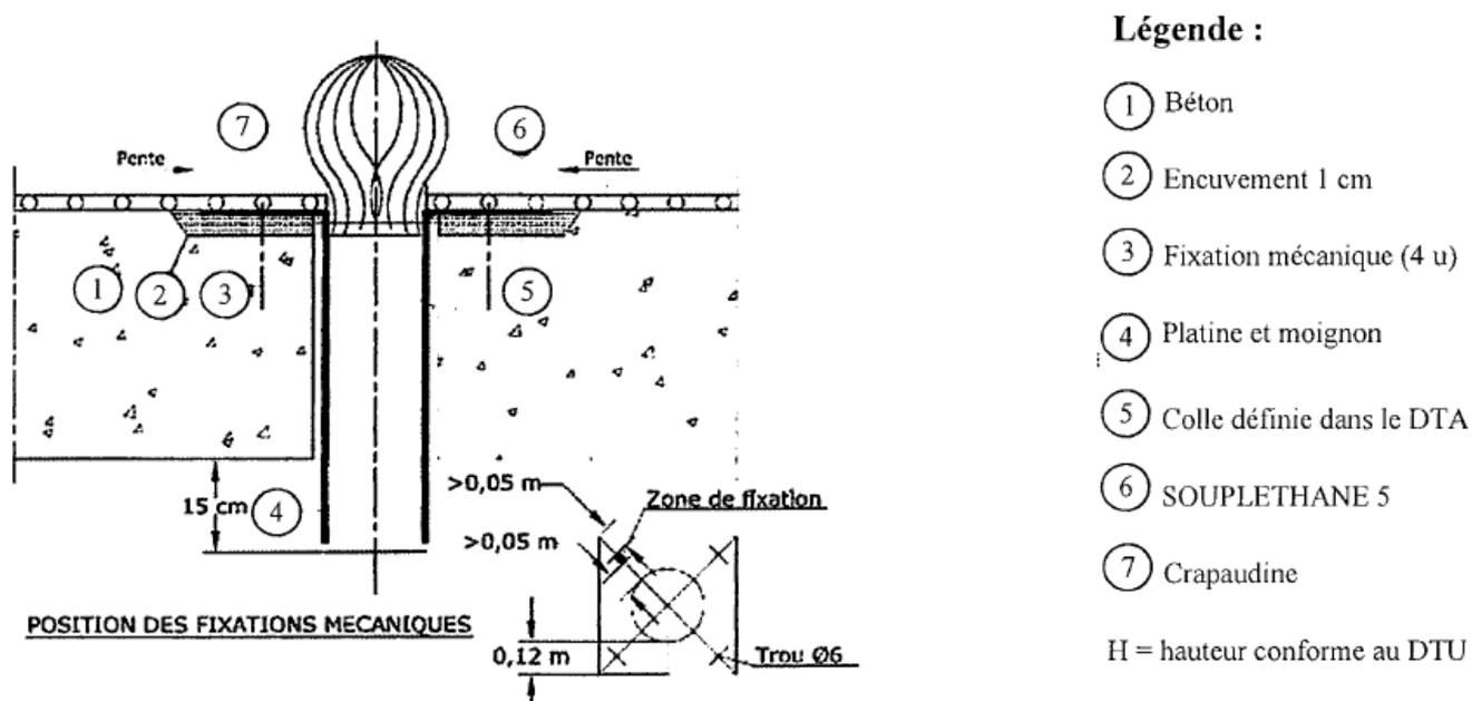
Figure 8 - Entrée d'eau pluviale
