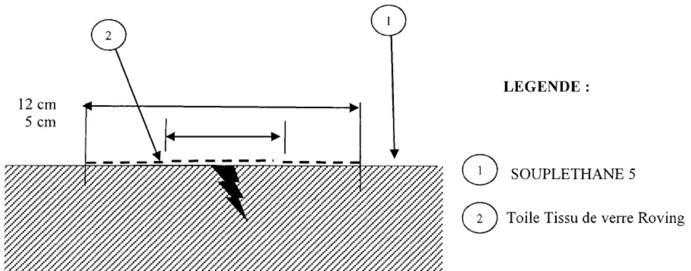
Figure 1 – Traitement des fissures d'ouverture de 0,3 à 2 mm
