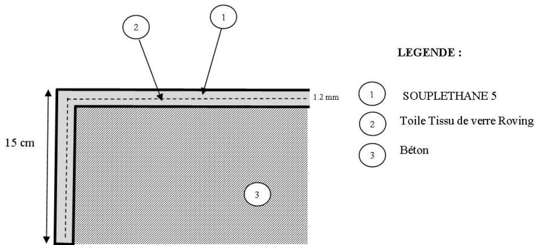
**Figure 5 – Traitement des rives et retombées (cas des retombées en balcon)**
